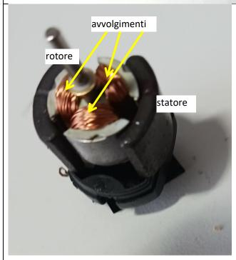
Sul ROTORE ci sono 3 avvolgimenti Lo STATORE è costituito da 2 calamite
