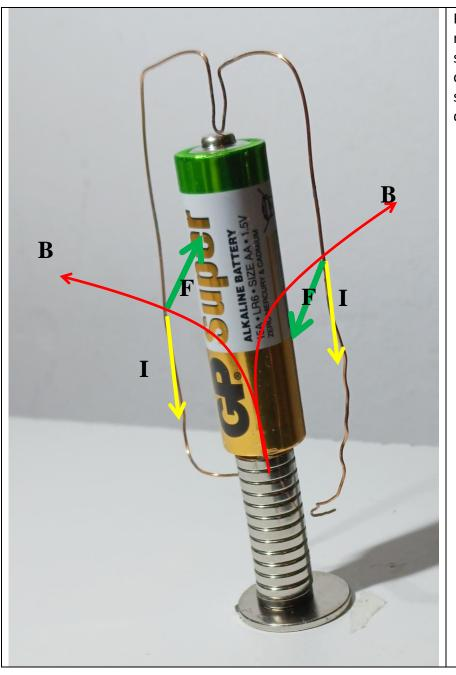
Per invertire il senso di rotazione: si cambia il verso della corrente capovolgendo la pila si cambia il verso di B capovolgendo il magnete
