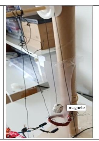
Un magnete, sospeso ad un filo che scorre su una carrucola, si muove e cambia il flusso magnetico che attraversa la bobina
