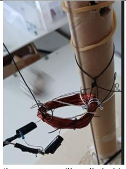
Il magnete oscilla sulla bobina Il flusso cambia perché cambia il campo e la superficie attraversata
